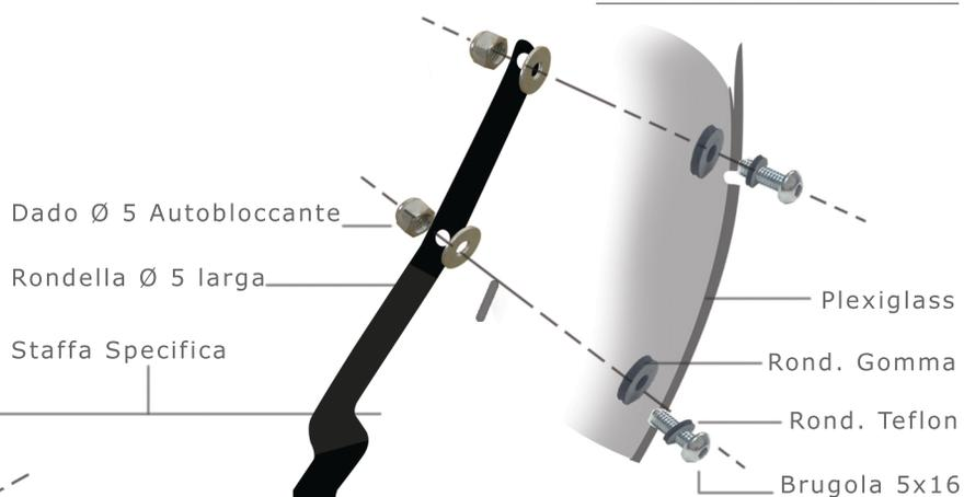
NOTE: NON SERRARE IN MODO ECCESSIVO ONDE EVITARE ROTTURE DEL PLEXIGLASS.
